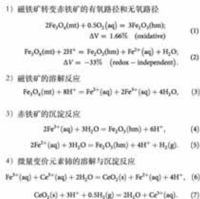
图 1 Fe(III)-Fe(II) 和 Ce(III)-Ce(IV) 的反应循环及相应的化学反应式 (Xing et al., 2021)
